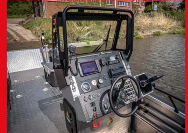
Die Funkausstattung sollte neben dem Betriebsfunk auch den BOS- und den UBI-Funk umfassen, um eine Kommunikation zwischen den verschiedenen Einheiten der Haupt- und ehrenamtlichen Kräfte, aber auch mit der Schifffahrt zu ermöglichen.
